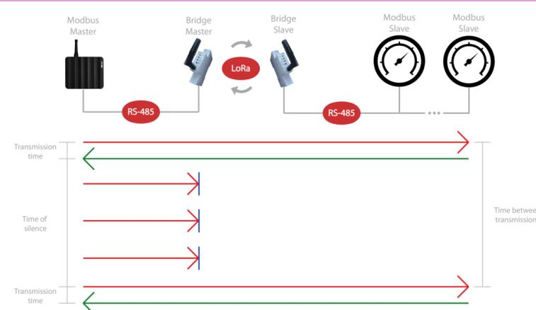
En base a aquests temps, s'estableixen 2 regles de comunicació que cal aplicar al Màster Modbus de la instal·lació. La primera, descrita a continuació, és completament essencial per establir comunicació sense fils amb els esclaus Modbus a través d'una xarxa sense fils SBL8:
