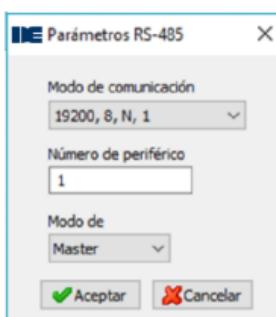
En accedir-hi podrem configurar els paràmetres Mode de comunicació, Número de perifèric, Modo de funcionament i Resposta en temps de silenci. El mode ens permetrà seleccionar si el SBL8 que estem configurant serà el Màster de la instal·lació o Slave. Si s'habilita 'Resposta en temps de silenci', el Màster SBL8 respondrà 'Busy' per la línia Modbus en cas de trobar-se durant el temps de silenci, mentre que si es manté deshabilitat no enviarà noves transmissions
