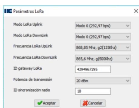
En accedir-hi podrem configurar els paràmetres Mode LoRa Uplink, Mode LoRa DownLink, Freqüència LoRa UpLink, Freqüència LoRa DownLink, ID gateway LoRa, Potència de transmissió i ID sincronització ràdio.
