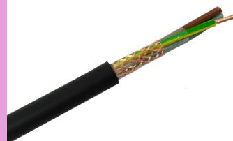
El cablejat de la comunicació RS-485 s'ha de fer amb cable apantallat i connectant la malla a terra únicament de l'extrem de què prové la comunicació.
